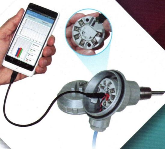
El TT22H es un transmisor de temperatura programable para montaje en cabezal, acepta sensores RTD y termocuplas y los convierte en señal de corriente estandar 4-20mA. El puerto USB tipo mini B permite la conexión del equipo con un celular Smartphone para poder realizar la configuración del tipo de sensor y el rango que se desea ajustar.
